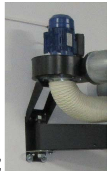
Montage des Ventilators direkt auf einem Absaugarm / Absaugkran
